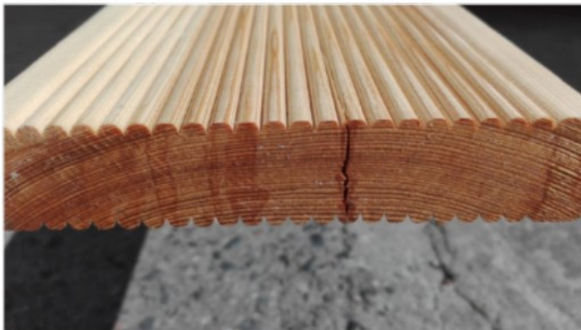
Fot. 18 - pęknięcie przechodzące czołowe
