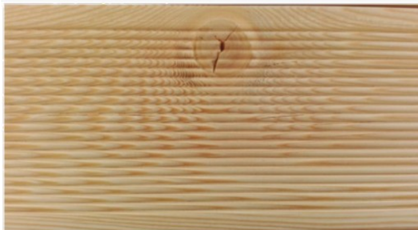
Fot. 13 - sęk spękany, niewykruszony
