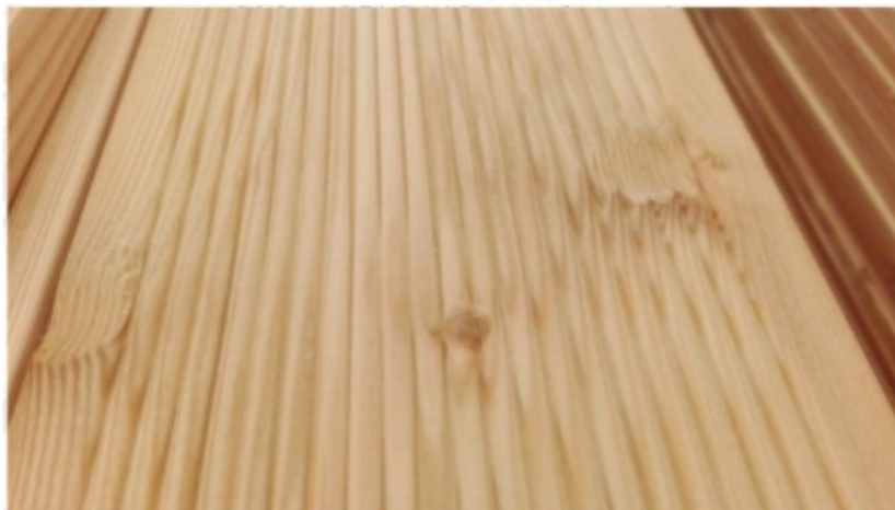
Fot. 22 - wyrwane włókna podczas obróbki
